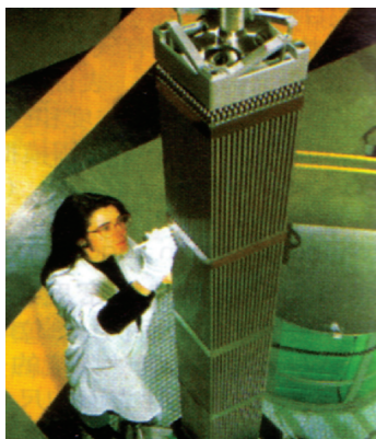
图 6-9 堆外检查压水堆新燃料组件
